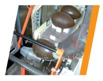
A máquina, nas suas partes em movimento, é completamente fechada. O ovo é carregado na catenária de alimentação pelo operador em condições de perfeita segurança. A base, extraída automaticamente por um carregador, é posicionada na cesta com o ovo e com ele transferida para a zona de embrulho. Simultaneamente, da bobina, é desenrolada a folha com o comprimento predefinido na tela, quer com impressão contínua, quer com imagem centrada.
