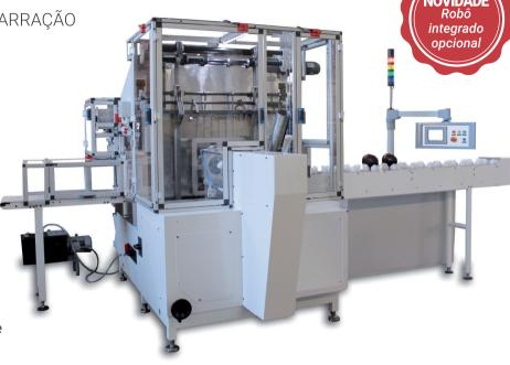
É possível trabalhar com bobinas de impressão contínua ou centrada por meio de células fotoelétricas. Fácil troca de formato com substituição de poucos elementos mecânicos e configurações dos parâmetros na tela da interface do operador. A amarração em laço garante uma selagem perfeita e permite uma fácil abertura puxando simplesmente uma das duas extremidades do cordão. A perfeita disposição das dobras da folha permite obter na saída um embrulho que necessita de mínimos ajustes finais.
